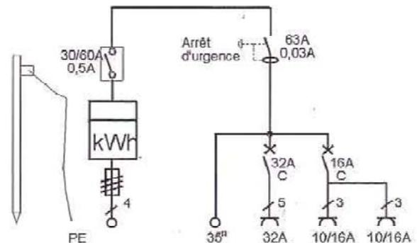
Remarque: Les fusibles et compteur sont fournis par EDF lors de la mise sous tension !
