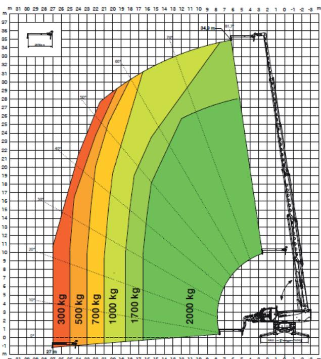
Abaque de charge avec nacelle extensible rotative
